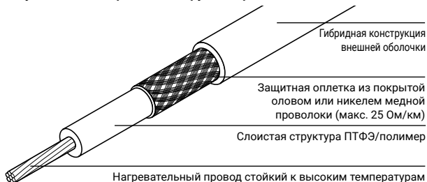
Рисунок 1. Стандартная конструкция греющего кабеля
